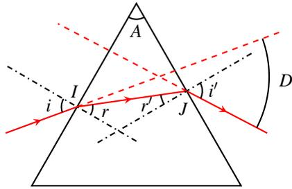
Un rayon incident arrivant sur un prisme d'indice  $n$  et d'angle au sommet  $A$  émerge en étant dévié d'un angle  $D$ . Le prisme est plongé dans l'air d'indice pris égal à 1,00.
