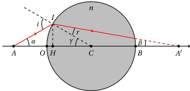
Un dioptré sphérique de centre  $C$  et de rayon  $R$  sépare l'air d'un MHTI d'indice de réfraction  $n$ . On cherche à déterminer la relation de conjugaison du dioptré sphérique dans les conditions de Gauss. Tous les angles sont supposés très faibles et on suppose le point d'incidence  $I$  suffisamment proche de l'axe pour pouvoir assimiler le point  $H$  (projeté orthogonal de  $I$  sur l'axe optique) au point  $O$  (on a donc  $CH \approx R$ ).
