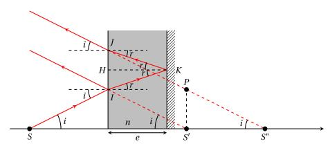
3. Pour déterminer la distance  $\overline{S'S''}$ , commençons par remarquer que S'P = IJ et que tan  $i = \frac{S'P}{S'S''}$  (triangle S'S''P).
