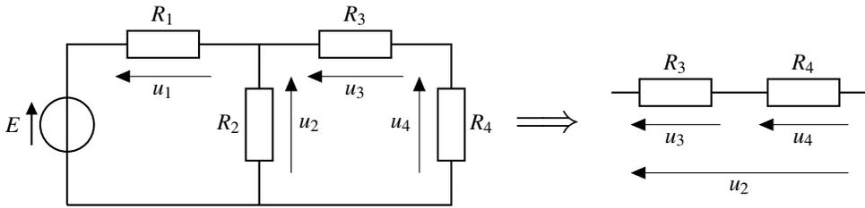
⚠ Les résistances  $R_1$  et  $R_2$  **ne sont pas en série**. On ne peut pas appliquer la loi du pont diviseur de tension avec  $R_1$  et  $R_2$ . En revanche on peut relier  $u_2$  à  $E$  avec un peu d'astuce. On simplifie le schéma du montage avec des associations de résistors. On commence par rassembler  $R_3$  et  $R_4$  en série (résistance équivalente  $R_{eq1} = R_3 + R_4$ ) puis on associe  $R_{eq1}$  et  $R_2$  en dérivation. La résistance équivalente vaut alors :
