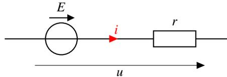
La relation courant-tension en convention générateur s'écrit  $u = E - ri$ , avec  $E$  la force électromotrice du générateur et  $r$  sa résistance interne.
