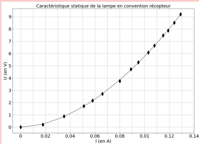
On alimente la lampe avec une pile de f.e.m.  $E = 7\text{ V}$  et de résistance interne  $r = 20\ \Omega$ .
