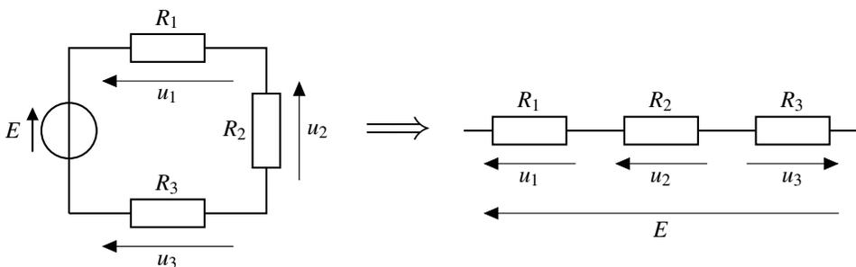
Dans ce montage la tension aux bornes de  $\{R_1, R_2, R_3\}$  est égale à  $E$ . On peut donc écrire :
