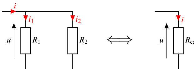
Il faut noter que lorsque l'on rassemble des résistances en dérivation on fait disparaître du schéma certaines intensités. En effet sur l'exemple ci-dessus les intensités  $i_1$  et  $i_2$  disparaissent et sont remplacées par l'intensité  $i = i_1 + i_2$  dans la branche de la résistance équivalente.
