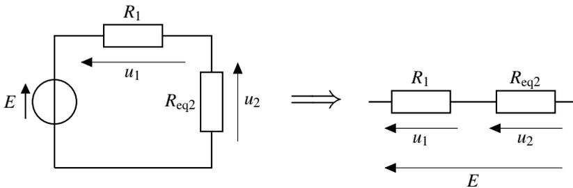
Désormais on a les résistances  $R_1$  et  $R_{eq2}$  en série. La tension aux bornes de  $\{R_1, R_{eq2}\}$  est égale à  $E$ . On peut écrire :
