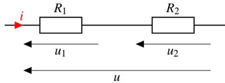
Si  $u$  est la tension aux bornes de l'ensemble  $\{R_1, R_2\}$  alors les tensions  $u_1$  et  $u_2$  aux bornes de chacun des résistors valent :
