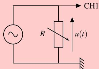
On commence par fixer  $R = \infty$  (la résistance variable se comporte comme un interrupteur ouvert) et on observe l'oscillogramme n°1 (voir ci-dessous). Ensuite on diminue progressivement la valeur de  $R$  jusqu'à obtenir l'oscillogramme n°2, montrant une tension deux fois plus faible que sur l'oscillogramme n°1 (la sensibilité verticale en V/div et la sensibilité horizontale en ms/div est la même pour les deux oscillogrammes).
