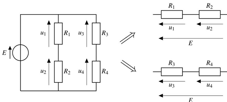
Dans ce montage les résistors  $R_1$  et  $R_2$  sont en série. La tension aux bornes de  $\{R_1, R_2\}$  est égal à  $E$ . On en déduit que :
