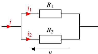
Si  $i$  est l'intensité dans l'ensemble des branches  $\{R_1, R_2\}$  alors les intensités  $i_1$  et  $i_2$  dans les branches de chacun des résistors valent :
