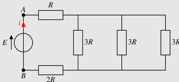
1. Déterminer la résistance équivalente entre  $A$  et  $B$  en fonction de  $R$ .
