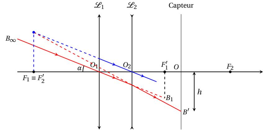
5. Pour déterminer la taille de l'image finale, on commence par déterminer la taille  $h_1 = A_1 B_1$  de l'image intermédiaire. Puisque l'objet est à l'infini, l'image intermédiaire est dans le plan focal image de  $(\mathcal{L}_1)$  et  $h_1 = \alpha f'_1$ .
