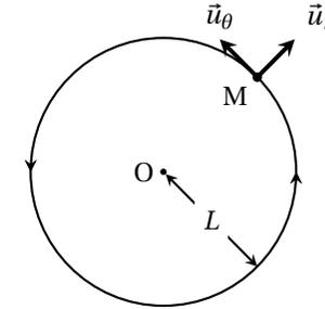
Comme les aiguilles tournent à vitesse angulaire  $\dot{\theta}$  constante alors le mouvement de la pointe d'une aiguille est **circulaire et uniforme**. On exprime les vecteurs position, vitesse et accélération dans la base polaire :
