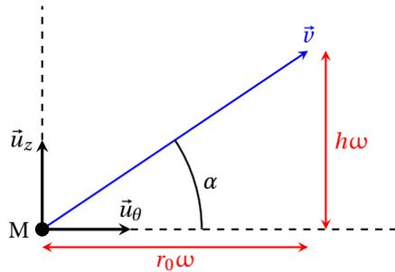
L'angle  $\alpha$  entre le vecteur vitesse et l'horizontale se calcule à partir des projections de  $\vec{v}$  dans la base cylindrique :
