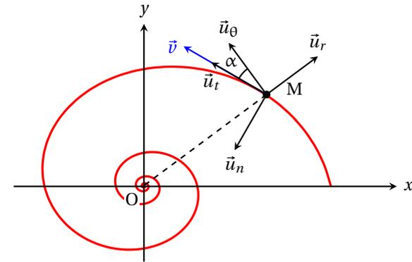
3. Par projection dans la base polaire, on a  $\vec{v} = \|\vec{v}\|(-\sin \alpha \vec{u}_r + \cos \alpha \vec{u}_\theta)$ . Par conséquent :
