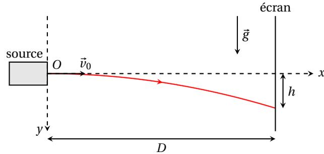
On applique le principe fondamental de la dynamique à la particule, soumise uniquement à son poids  $\vec{P}$ , dans le référentiel terrestre supposé galiléen :  $m\vec{a} = \vec{P} \Leftrightarrow \vec{a} = \vec{g}$ . On projette cette équation dans la base  $(\vec{u}_x, \vec{u}_y)$  :
