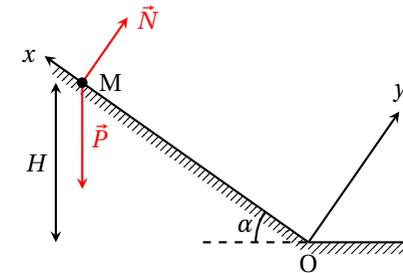
On applique le PFD à la masse dans le référentiel terrestre supposé galiléen. En l'absence de frottement, la masse n'est soumise qu'à son poids et à la réaction normale du plan incliné :
