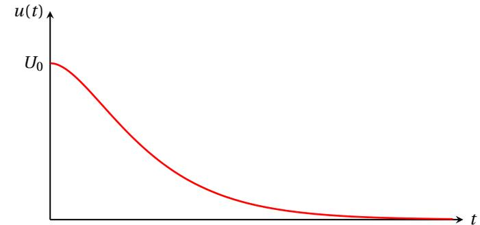
3. On calcule l'intensité (définie en convention récepteur) :  $i(t) = C \frac{du}{dt} = -CU_0 \lambda^2 t e^{-\lambda t}$ .
