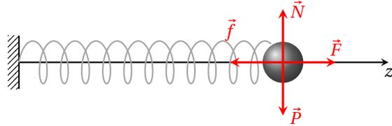
On applique le principe fondamental de la dynamique à la masselotte dans le référentiel terrestre supposé galiléen :  $m\vec{a} = \vec{P} + \vec{N} + \vec{F} + \vec{f}$ . On le projette sur  $\vec{u}_z$  :
