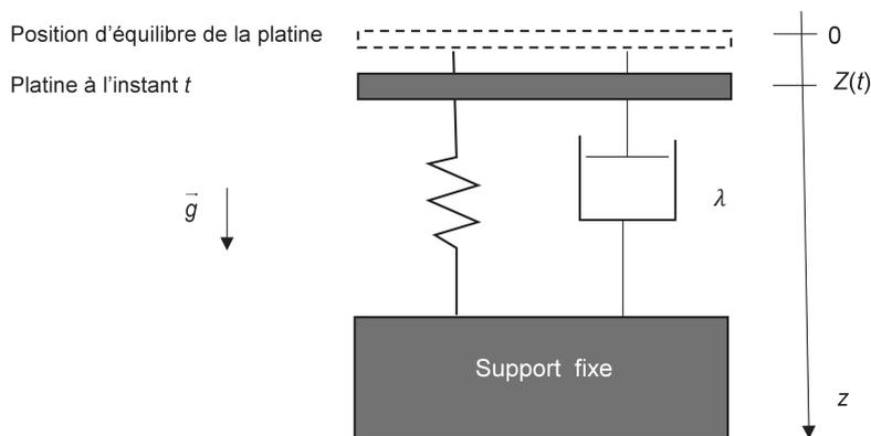
Il se compose d'une platine sensible recevant les gouttes de pluie ayant atteint leur vitesse limite et d'un système de traitement permettant la mesure de celle-ci.
