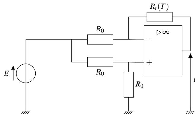
Le montage comprend un générateur idéal de tension continue de force électromotrice  $E = 400 \text{ V}$  et un ALI idéal dont l'alimentation ( $+15 \text{ V}$ ,  $-15 \text{ V}$ ) n'est pas représentée.
