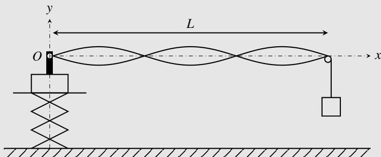
Une corde est attachée en  $O$  à un vibreur qui communique à l'une de ses extrémités un mouvement vertical sinusoïdal, de fréquence  $f$  fixée à l'aide d'un GBF. La corde au repos est maintenue en position horizontale grâce à une poulie. Elle est tendue à l'aide d'une masse accrochée à son autre extrémité. On note  $L$  la longueur vibrante de la corde,  $c$  la célérité et  $y(x,t)$  la déformation transversale d'un point de la corde.
