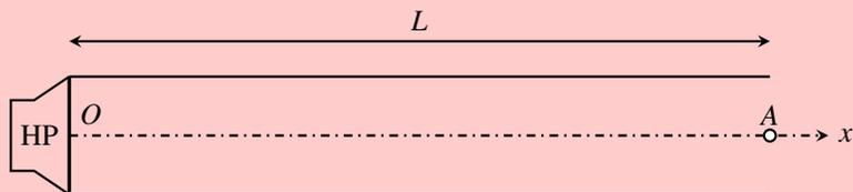
On observe que les ondes se superposent dans le tuyau pour former une onde stationnaire. On admet les conditions limites suivantes : il y a un nœud de surpression au niveau du haut-parleur et un ventre de surpression en  $A$  au niveau de l'extrémité ouverte.
