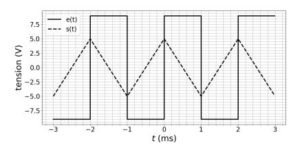
7. Voir cours : l'impédance d'entrée du montage est :  $\underline{Z_e} = R$ . Ce n'est pas idéal, il serait préférable d'avoir une impédance d'entrée infinie afin d'éviter une possible chute tension entre l'intégrateur et le montage situé en amont.
