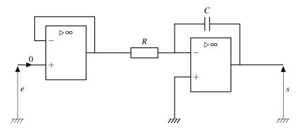
**8.** Un condensateur se comporte comme un interrupteur ouvert en BF et un court-circuit en HF. C'est le contraire pour une bobine. On représente ci-dessous le schéma équivalent du filtre en BF et en HF (c'est le même dans les deux cas) et on détermine la tension de sortie.
