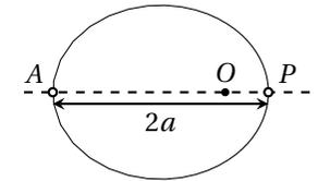
Dans le cas d'une trajectoire elliptique, on retient que l'expression de la période et de l'énergie mécanique est semblable au cas circulaire, en remplaçant le rayon  $R$  par le demi-grand axe  $a$  de l'orbite :
