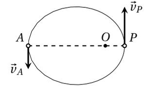
Le péricentre et l'apocentre sont les deux seuls points de l'orbite pour lesquels la vitesse est **orthoradiale**. En effet en ces points  $r$  est minimal ou maximal donc  $\dot{r} = 0$  et  $\vec{v} = r\dot{\theta}\vec{u}_\theta$ . La loi des aires permet alors d'écrire une relation simple entre les rayons et les vitesses en  $A$  et  $P$  :  $r_A v_A = r_P v_P$ .
