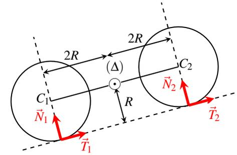
Les réactions normales  $\vec{N}_1$  et  $\vec{N}_2$  ont un bras de levier égal à  $2R$ . Les réactions tangentielles  $\vec{T}_1$  et  $\vec{T}_2$  ont un bras de levier égal à  $R$ . On peut conclure :
