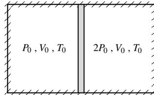
On libère le piston. Il se déplace en translation sans frottement et finit par s'immobiliser dans une nouvelle position d'équilibre. Calculer la température, la pression et le volume de chaque compartiment dans l'état final.
