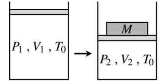
1. On pose sur le piston une masse  $M$ . Après un certain temps, l'air du récipient se trouve à la température  $T_0$  et le piston se stabilise. Déterminer l'état final  $(P_2, T_0, V_2)$  et calculer le travail  $W$  reçu par l'air intérieur.
