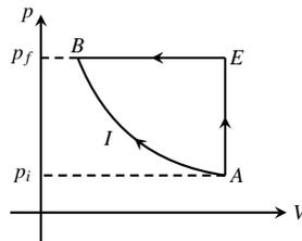
1. Calculer le travail puis le transfert thermique reçu par le gaz au cours de l'évolution  $AIB$ .
