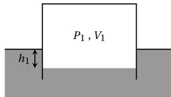
On suppose qu'à tout instant l'air emprisonné sous la cloche est en équilibre thermique avec l'eau et l'atmosphère, à la température  $T_0$ . On négligera la masse volumique de l'air devant celle de l'eau et l'on supposera la pression de l'air (que l'on assimilera à un gaz parfait) uniforme à l'intérieur de la cloche.
