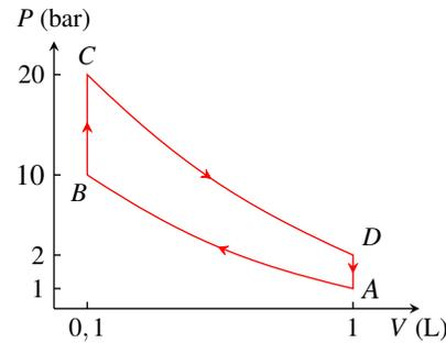
3. Le transfert thermique reçu du thermostat  $\Sigma_2$  est  $Q_c = Q_{BC} + Q_{CD}$ .
