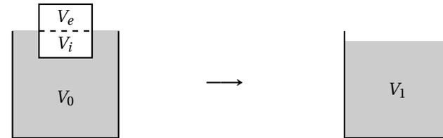
Dans l'état initial, on note  $V_e$  le volume émergé du glaçon,  $V_i$  le volume immergé dans l'eau liquide et  $V_g = V_i + V_e$  le volume total du glaçon. On note  $V_0$  le volume d'eau liquide et  $V$  le volume total du verre. Dans l'état final, on note  $V_1$  le volume d'eau liquide.
