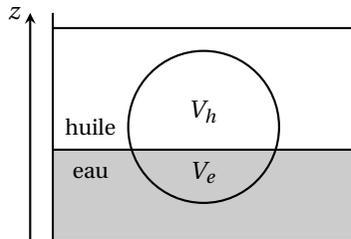
On note  $V_h$  le volume de la bille immergé dans l'huile,  $V_e$  le volume immergé dans l'eau et  $V = V_h + V_e$  le volume total de la bille. Pour étudier l'équilibre mécanique de la bille, on applique le PFD. La bille est soumise à son poids ainsi qu'aux poussées d'Archimède exercée par l'huile et l'eau :
