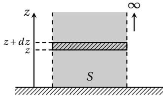
2. La masse contenue dans la tranche d'air cylindrique infinitésimale vaut  $dm = \rho(z)Sdz$ .
