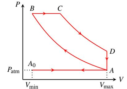
7. En pratique le rendement est plus faible car il y a des sources d'irréversibilité que l'on a négligé dans ce modèle, notamment lors des phases de compression et de détente qui ne sont pas véritablement réversibles.
