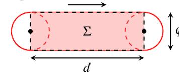
Le volume d'aluminium qui doit se vaporiser est  $V = \Sigma e = e \phi V \Delta t$ , ce qui correspond à une masse  $m = \rho V = \rho e \phi V \Delta t$ . Pour vaporiser entièrement cette masse d'aluminium il faut que la durée  $\Delta t$  soit au moins égale à celle calculée à la question 4 :
