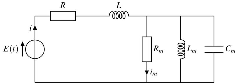
Schéma-modèle d'un haut-parleur électrodynamique en régime forcé
