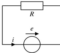
On détermine l'intensité à l'aide de la loi d'Ohm :  $i = \frac{e}{R} = -\frac{Bd}{R}\dot{z}$ .
