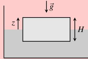
Établir l'équation du mouvement vérifiée par  $z(t)$  si le cylindre reste toujours immergé en partie dans le liquide. Justifier que les déplacements verticaux sont des oscillations harmoniques et exprimer leur période en fonction de  $\rho_c$ ,  $\rho_\ell$ ,  $g$  et  $H$ .
