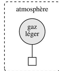
**!** Il faut retenir qu'un ballon est toujours constitué d'une partie solide (enveloppe, matériel, nacelle, passagers, etc) et d'une partie gazeuse (à l'intérieur de l'enveloppe). Ainsi la masse totale du ballon doit être décomposée en deux termes :  $m_{\text{ballon}} = m_{\text{solide}} + m_{\text{gaz interne}}$ .
