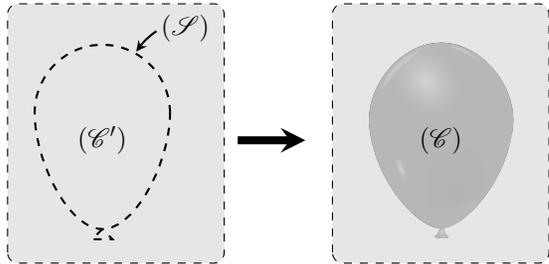
$(\mathcal{C}')$  est appelé *fluide déplacé* car il s'agit du volume de fluide dont  $(\mathcal{C})$  **prend la place** lorsqu'il est immergé. On note  $m'$  sa masse.
