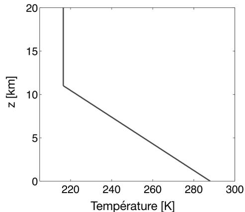
*Profil vertical de température du modèle international d'atmosphère standard utilisé en aéronautique. La partie affline ( $z < 11$  km) correspond à la troposphère et la partie stationnaire ( $z > 11$  km) à la stratosphère*
