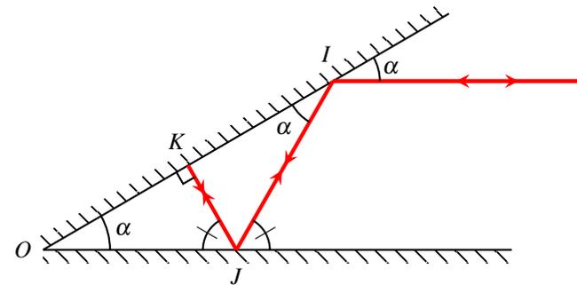
Pour émerger des miroirs en suivant le même chemin en sens inverse, il faut nécessairement qu'à mi-chemin, le rayon subisse une réflexion sous incidence normale (en K).
