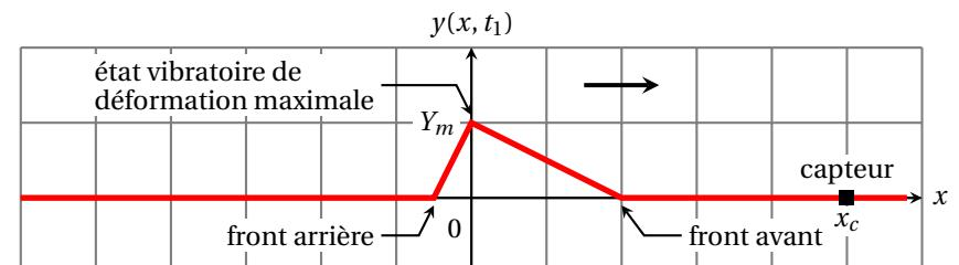
Un état vibratoire correspond à une valeur particulière prise par le signal au cours du passage de l'onde. Imaginons un capteur, placé dans une position  $x_c$  donnée, et qui enregistre la vibration  $t \mapsto y(x_c, t)$  au cours du temps.
