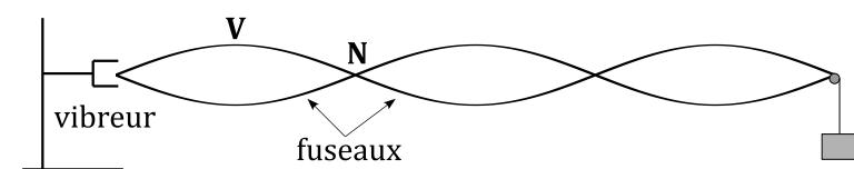
Les vibrations de la corde sont quasi-nulles, sauf lorsque la fréquence est celle d'un mode propre. On voit alors apparaître des fuseaux, caractéristiques de l'apparition d'une onde stationnaire dans le système. Plus la fréquence augmente et plus le nombre de fuseaux augmente (normal car  $\lambda$  diminue lorsque  $f$  augmente).
