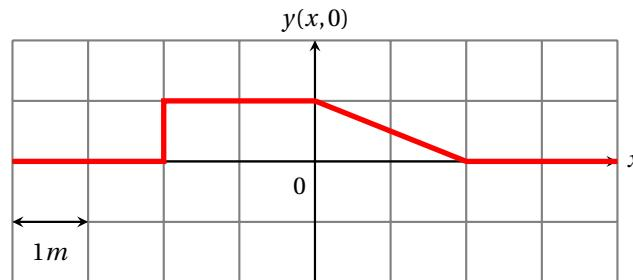
Le graphe ci-dessus représente, à la date  $t = 0$ , la forme d'une onde progressive se propageant le long d'un axe ( $Ox$ ) dans le sens des  $x$  croissants avec une célérité  $c = 0,5 \text{ m} \cdot \text{s}^{-1}$ .
