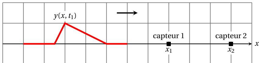
Le capteur enregistre d'abord le passage du front avant de l'onde (front lentement montant), puis celui du front arrière de l'onde (front rapidement descendant). On peut alors tracer qualitativement l'allure du signal temporel enregistré par le capteur (voir figure ci-dessous).
