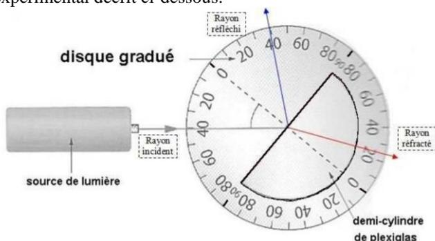
A l'aide d'une source de lumière on éclaire avec un pinceau lumineux fin le centre de la face plane d'un demi-disque de plexiglas. Un rapporteur permet alors de relever la valeur numérique des trois angles d'intérêt :
