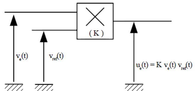
18. Exprimer le signal  $u_e(t)$  en sortie du multiplieur sous la forme d'une somme de signaux sinusoïdaux (dont une composante constante).
