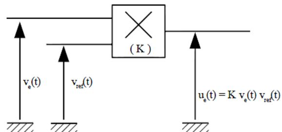
10. Exprimer le signal  $u_e(t)$  à la sortie du multiplicateur sous la forme d'une somme de deux composantes sinusoïdales en précisant les amplitudes et les fréquences de ces deux composantes. Tracer alors le spectre du signal  $u_e(t)$ .
