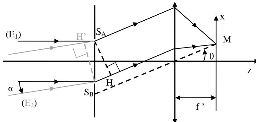
Pour étudier cette configuration, on exploite le théorème de Malus qui affirme que les points sur un même front d'onde sont en phase. On en déduit que les chemins optiques  $(E_1S_A)$  et  $(E_1S_B)$  sont identiques ainsi que les chemins optiques  $(S_A M)$  et  $(H M)$ .
