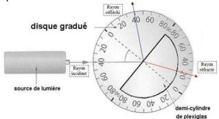
A l'aide d'une source de lumière on éclaire avec un pinceau lumineux fin le centre de la face plane d'un demi-disque de plexiglass. Un rapporteur permet alors de relever la valeur numérique des trois angles d'intérêt :
