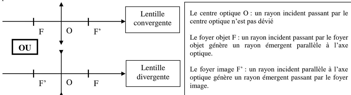
Ces règles de construction permettent d'établir les relations avec origine au centre optique suivantes pour un objet AB situé dans un plan de front de la lentille (A étant situé le long de l'axe optique).
