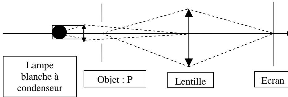
**b. Condition d'observation d'une image réelle à partir d'un objet réel pour une lentille convergente.**
