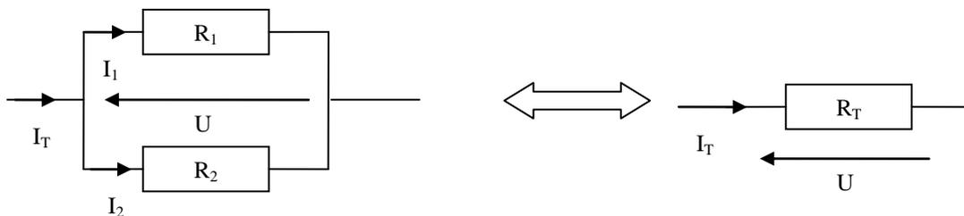
La loi d'Ohm aux bornes de chaque résistance s'écrit :  $U = R_1 I_1$  ;  $U = R_2 I_2$  ;  $U = R_T I_T$
