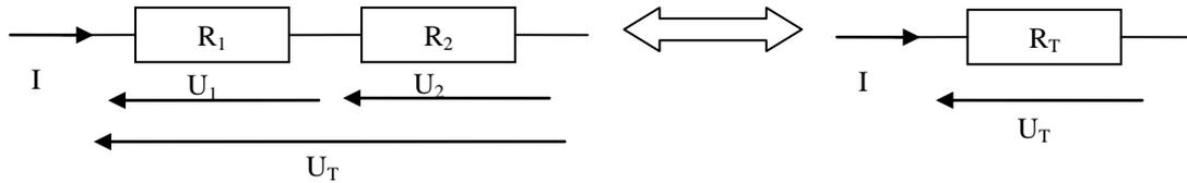
La loi d'Ohm aux bornes de chaque résistance s'écrit :  $U_1 = R_1 I$  ;  $U_2 = R_2 I$  ;  $U_T = R_T I$
