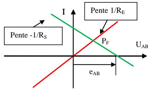
Le générateur n'impose donc pas parfaitement la tension de commande  $e_{AB}$  au circuit mais une valeur dépendant de la résistance d'entrée du circuit qu'il alimente et de sa propre résistance de sortie.
