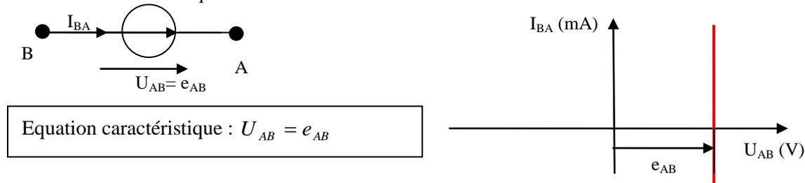
**Source de courant idéale :** Une source idéale de courant impose la valeur de l'intensité  $\eta_{BA}$  qui la traverse et peut délivrer à ses bornes n'importe quelle tension. Elle est symbolisée de la façon suivante et sa caractéristique est une droite horizontale.
