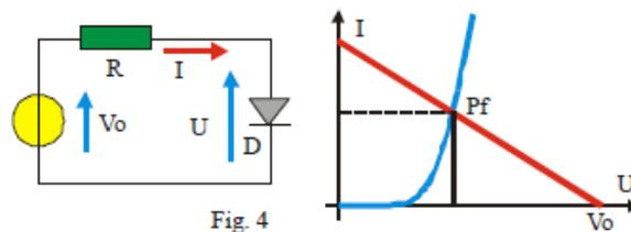
Le point de fonctionnement du système  $P_f$  est obtenu aux croisements des deux caractéristiques statiques.
