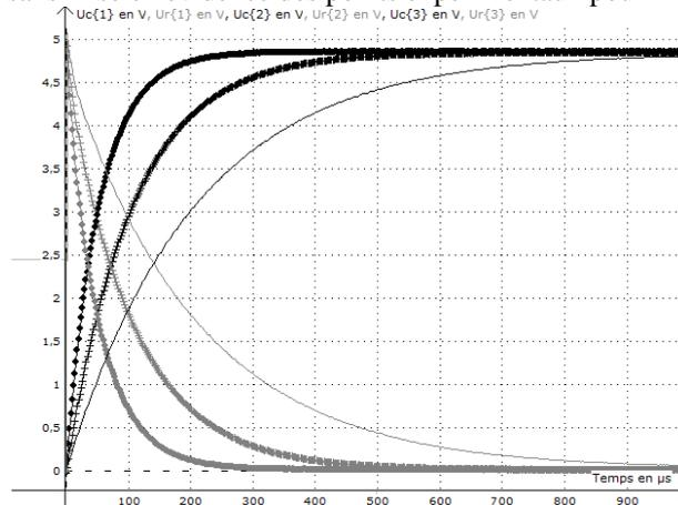
On observe sur la courbe expérimentale relevée pour la tension  $U_C$  aux bornes du condensateur :
