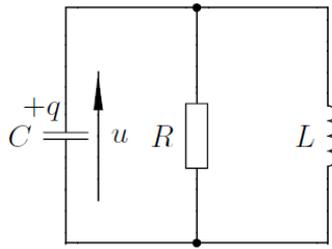
Un condensateur est chargé et présente alors une tension constante  $U_0$  sur l'intervalle de temps  $t < 0$ . A l'instant initial, on le connecte à un circuit constitué d'un conducteur ohmique et d'une bobine en parallèle dans lequel ne circule aucun courant sur l'intervalle de temps  $t < 0$ .
