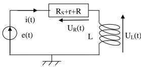
2. On étudie le circuit en régime stationnaire avec une fem nulle en entrée et la bobine remplacée par un fil. On trouve alors que la tension aux bornes de la résistance équivalente est nulle et par la loi d'Ohm on obtient i(t = 0-) = 0.
