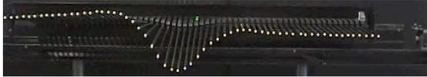
L'échelle de perroquet est un système composé de barreaux métalliques disposées à intervalle régulier le long d'une lame métallique.
