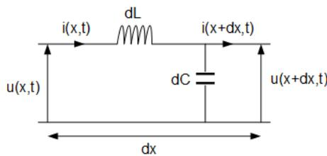
Dans un câble coaxial, les grandeurs physiques support de l'onde électrique sont la tension  $U(t,x)$  entre le cœur et la gaine du câble et l'intensité électrique  $I(t)$  qui circulent dans ce câble.
