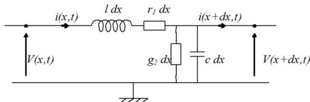
Dans une modélisation tenant compte du caractère non idéal du câble, on introduit les pertes par effet Joule lors de la propagation du courant dans l'âme et la gaine et les pertes par fuite entre le conducteur et la gaine.
