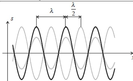
Onde stationnaire représentée à  $t_1$  (en noir),  $t_2$  (en gris épais),  $t_3 = t_1 + T/2$
