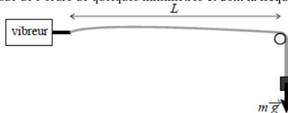
Lorsqu'on augmente progressivement f, on constate que la corde prend, pour certaines fréquences particulières, un mouvement d'amplitude très supérieure à l'amplitude du vibreur, pouvant valoir une dizaine de centimètres.
