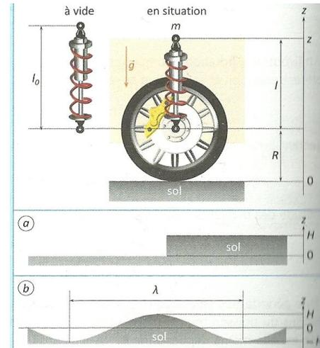
Le véhicule rencontre une marche de hauteur  $H$ . En première approximation on suppose le pneu et la roue indéformables. On considère qu'il poursuit sa route à la même vitesse horizontale  $v$ .
