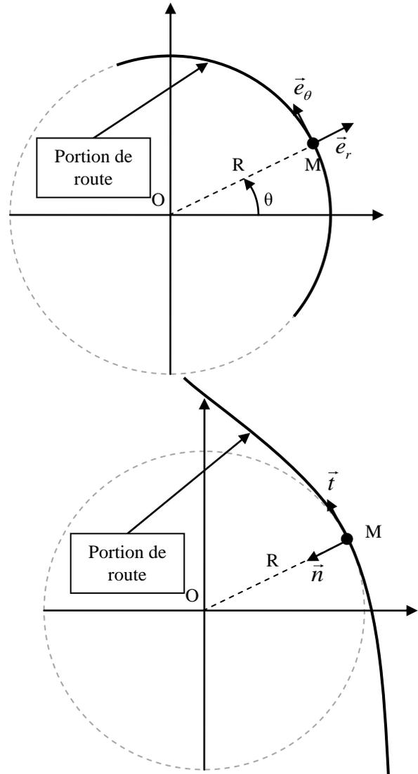
4. Pour une vitesse  $v_0$  le rayon minimal  $R_{\min}$  est exprimé en traduisant le critère donné :  $\|\vec{a}_{M/R}\| = \frac{v_0^2}{R} < \mu g$
