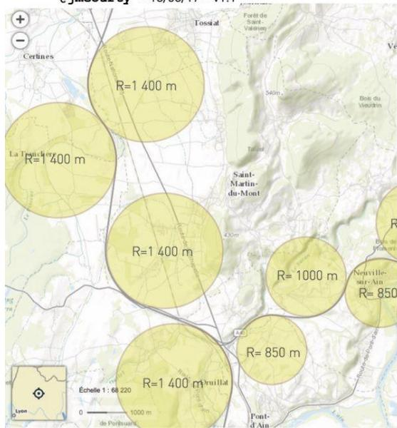
Mesure : Autoroute A40 Section à 130 km/h : rayon = 1 400 m
