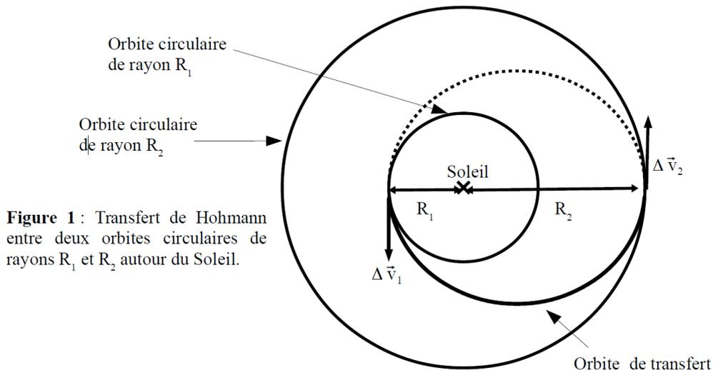
**Figure 1 :** Transfert de Hohmann entre deux orbites circulaires de rayons  $R_1$  et  $R_2$  autour du Soleil.
