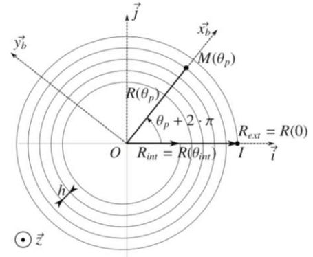
Le rayon extérieur du disque est  $R_{ext}=150\text{mm}$ , le rayon intérieur est  $R_{int}=75\text{mm}$ . On prend comme conditions initiales  $\theta_p(t=0)=0$  ;  $R(t=0)=R_{ext}$ .
