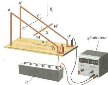
On suppose que le seul mouvement possible de la tige est une translation le long de la direction des rails et on note  $M$  et  $N$  les points de contacts sur les rails.
