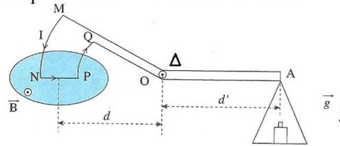
Le champ magnétique sujet de la mesure est supposé uniforme et localisé dans la région grisée. L'équilibre
