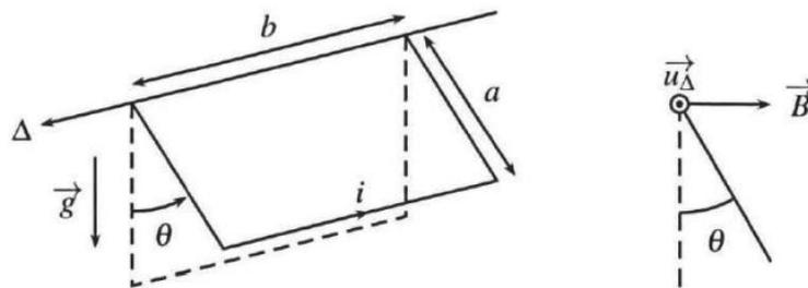
Le cadre est placé dans un champ de pesanteur et un champ magnétique. Le champ magnétique est horizontal placé dans un plan perpendiculaire à  $\Delta$ .
