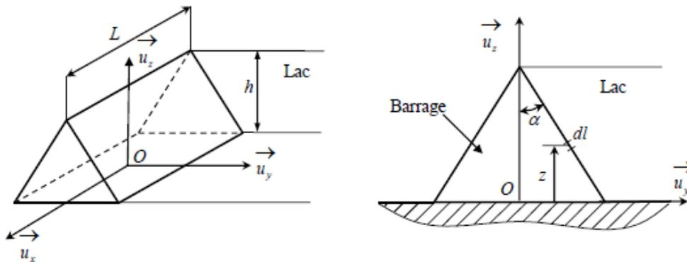
L'eau est supposée incompressible de masse volumique  $\rho_e$ , la masse volumique de l'ouvrage est notée  $\rho_b$ . La longueur  $L$  du barrage est supposée suffisamment grande pour que les forces de liaison intervenant à ses extrémités soient négligeables.
