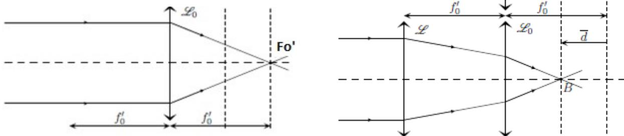
Il faut d'abord réaliser un objet à l'infini. Pour cela, on place la lettre P dans le plan focal objet d'une lentille convergente. On place alors une lentille  $L_0$  convergente de distance focale  $f'_0$  sur le banc qui réalise donc une image de la lettre A dans son plan focal image.
