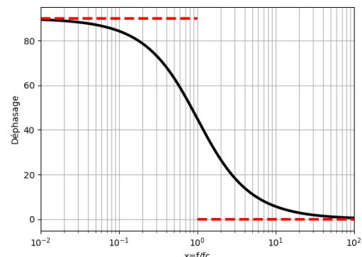
9. La fréquence de coupure du filtre s'exprime  $f_o = \frac{\omega_o}{2\pi} = \frac{R}{4\pi L_e}$  A.N :  $f_o = 1,0\text{kHz}$ , on peut donc estimer que  $f=4\text{kHz}$  est dans le domaine HF pour lequel  $\underline{T} = T_o = \frac{\Delta z}{\delta}$
