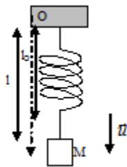
On considère un point matériel de masse  $m$  relié à l'aide d'une ressort à un point fixe du bâti d'un sismographe. On suppose qu'il existe une force de frottement visqueux s'appliquant sur le point matériel.
