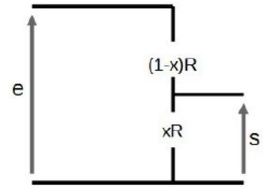
b) La sortie n'est plus ouverte : les intensités se divisent, on ne peut donc plus appliquer directement le diviseur de tension.
