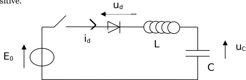
1°) Dans un premier temps, le condensateur étant déchargé, on peut supposer la diode **passante**, notion liée au sens du courant qui la traverse :
