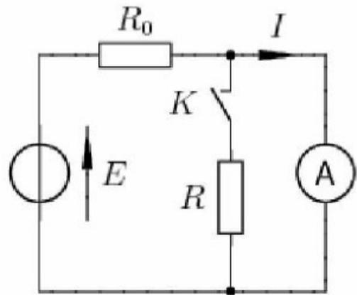
1. Lorsque l'interrupteur K est ouvert, quelle est l'intensité  $I_0$  mesurée par l'ampèremètre si l'on suppose qu'il est idéal, c'est à dire si sa présence ne modifie en rien les grandeurs électriques présentes dans le circuit ?
