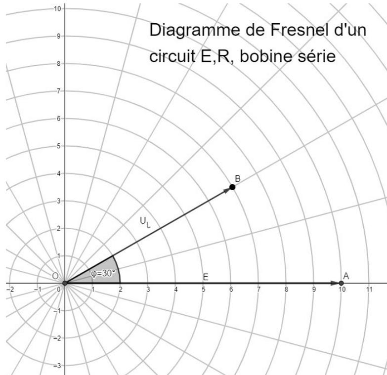
On note  $u_L(t)$  et  $u_R(t)$  les tensions respectivement aux bornes de la bobine et de la résistance.
