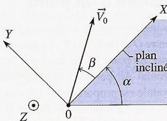
Déterminer  $\beta$  pour que le projectile repasse par son point de départ. Effectuer l'application numérique pour  $\alpha = 30^\circ$ .
