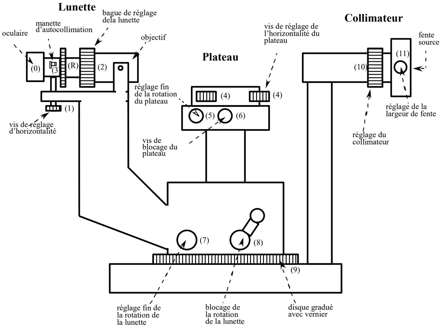
Le goniomètre se compose d'un bâti massif sur lequel sont montés 3 accessoires :
