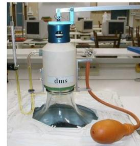
L'atmosphère extérieure est à  $(T_0, P_0)$ . Le récipient ci-dessus contient, au début, un gaz à  $(T_0, P_0)$  que l'on supposera toujours parfait. A l'aide de la pompe, on injecte dans le récipient une petite quantité du même gaz. On attend que la température du gaz du récipient soit stabilisée à  $T_0$ ; il y a alors une quantité de matière  $n_0$  de gaz dans le récipient (« gaz étudié » de volume  $V$  sur le schéma de principe)
